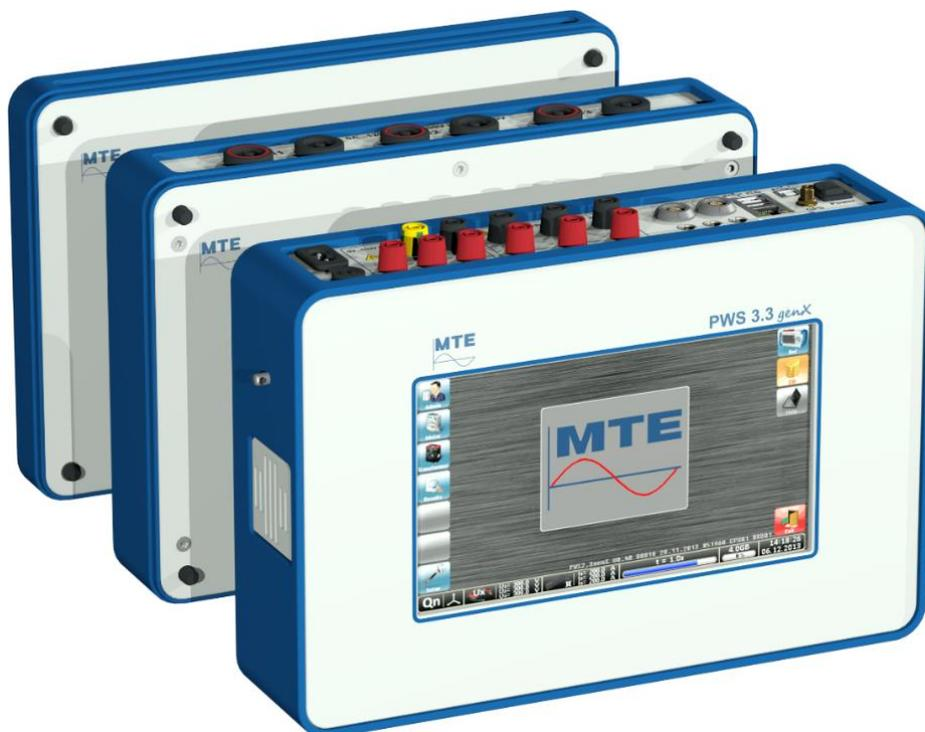
El PWS 3.3 genX es una combinación de un patrón de referencia trifásico de clase 0.05% y de un analizador de calidad de redes compatible según IEC 61000-4-30 Clase A con 4 canales de tensiones (U1, U2, U3, UN, UPE) y 4 canales de corriente (directa: I1, I2, I3 y vía Pinzas de corriente: corriente de Neutro IN o corriente de Protección a Tierra IPE).
